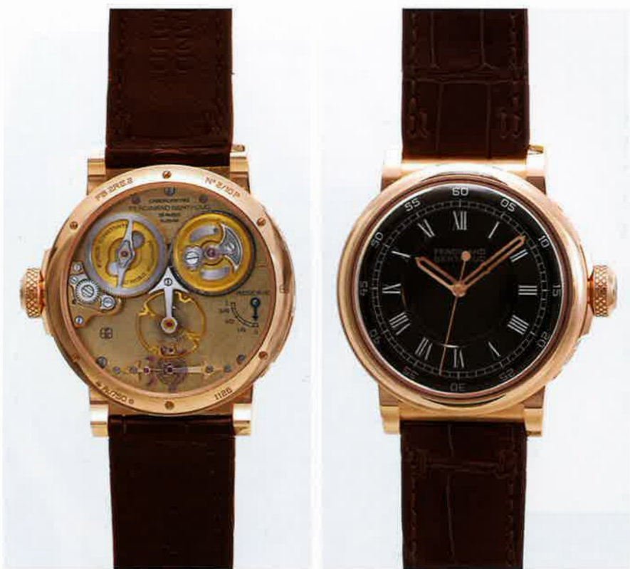
ケース：直径44mm、18Kローズゴールドもしくはホワイトゴールド、30m防水、シースルー・バック+側面に絛窓●ムーブメント：片持ちの吊り下げ式フュゼ・チェーン、およびルモントワール機構を装備したCal.FB-RE.FC (58石、1万8000振動、パワー・リザーブ約50時間、COSCクロノメーター仕様)●価格：ともに2941万4000円
